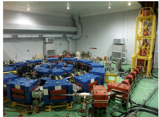
京大 FFAG 陽子加速器複合系：負素子イオン線形加速器と FFAG シンクロンを用いて陽子ビームを 150MeV まで加速し、隣接する臨界集合体にビームを導入する。
